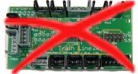
Die TrainLine-Originalplatine, welche zu entfernen ist
