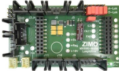
Jumper X13 (FA2) entfernt, TR92 geschlossen
