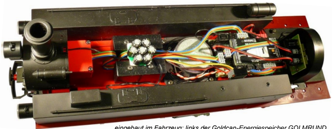
... eingebaut im Fahrzeug; links der Goldcap-Energiespeicher GOLMRUND
